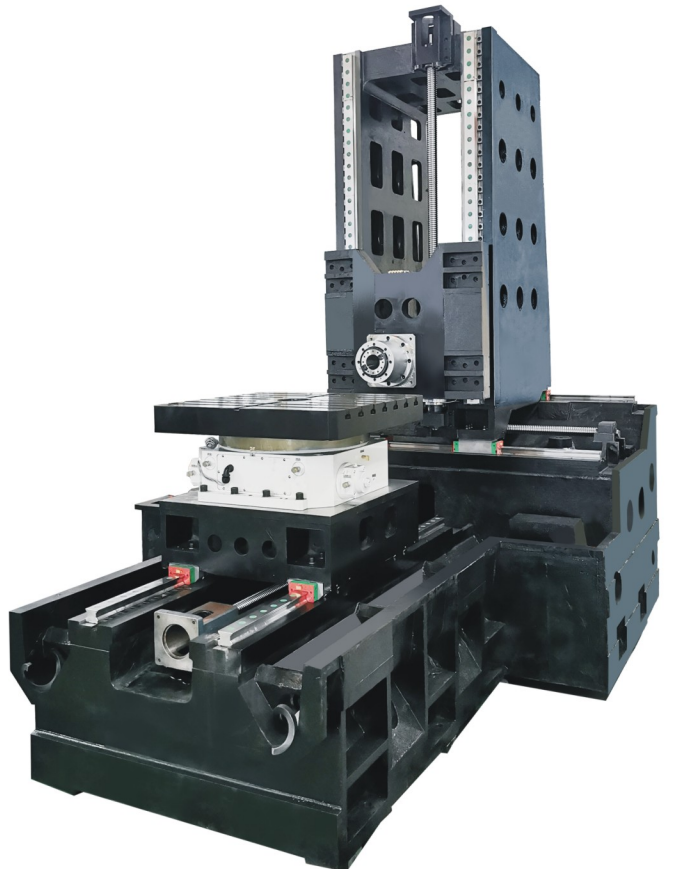
旋转工作台(B轴) | -旋转工作台采用伺服系统 -采用三片式离合盘(精度可达±5°) 以确保定位精度
